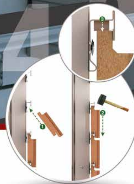
УСТАНОВКА ОБЛИЦОВОЧНОЙ ПЛИТКИ ФИКСАЦИЯ ПРИЖИМНЫМ ЛЕПЕСТКОМ
