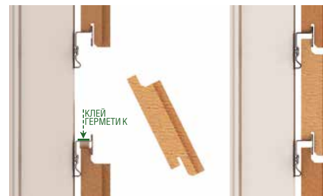
УСТАНОВКА ОБЛИЦОВОЧНОЙ ПЛИТКИ ФИКСАЦИЯ ПРИЖИМНЫМ ЛЕПЕСТКОМ
